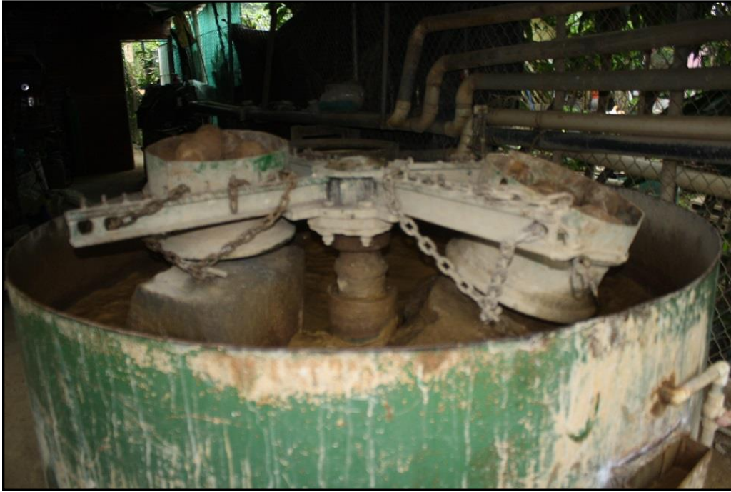
Fig.25: Rastra artesanal utilizada por los mineros para la recuperación del oro con uso de mercurio.
