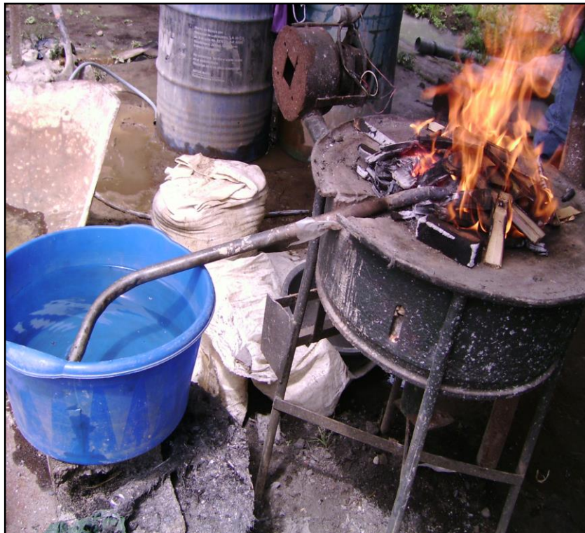
Fig.26: Retorta utilizada para la recuperación del mercurio en la cubeta con agua. Foto Sirzabel Ruiz
