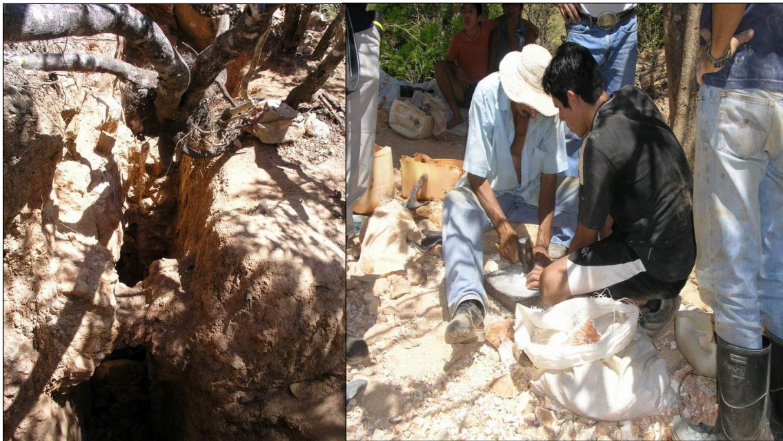
Fig.31: (Soto, 2005) Laboreo superficial artesanal, donde los mineros locales ilegales explotan a mano la ganga de cuarzo. La prueba de concentración metálica se realiza en una pala después de moler la muestra de ganga con martillo.
