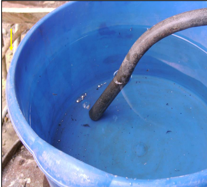
Fig.27: Recuperación del mercurio por quemado y destilado a través del tubo de la retorta. La flecha indica el mercurio recuperado en la cubeta con agua. Foto Sirzabel Ruiz.
